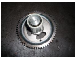
名称: クランクギヤ 材質: 合金鋼SCM435 硬度: 50~56(HRC)
