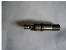
名称: 中継ピン 材質: ステンレスSUS440 硬度: 50~55(HRC)
